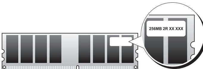
**ANMERKUNG:** Installieren Sie DDR2-Speichermodule immer in der Reihenfolge, wie sie auf der Systemplatine angegeben ist.
